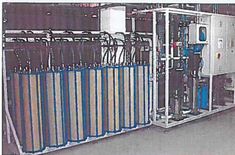
Fig. 12 Stație-container cu module de osmoza inversă
